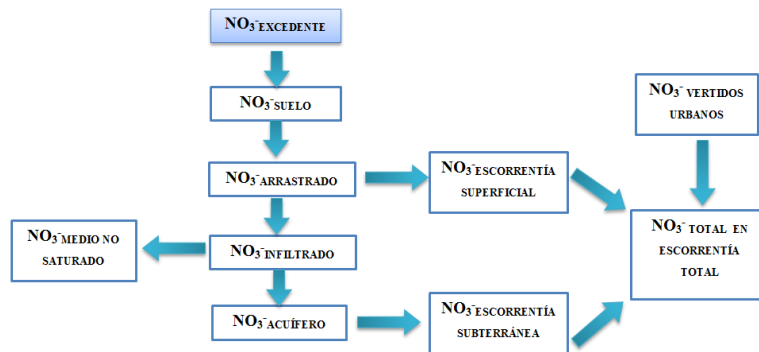
Figura 1. Esquema conceptual del transporte del nitrato en el modelo PATRICAL
